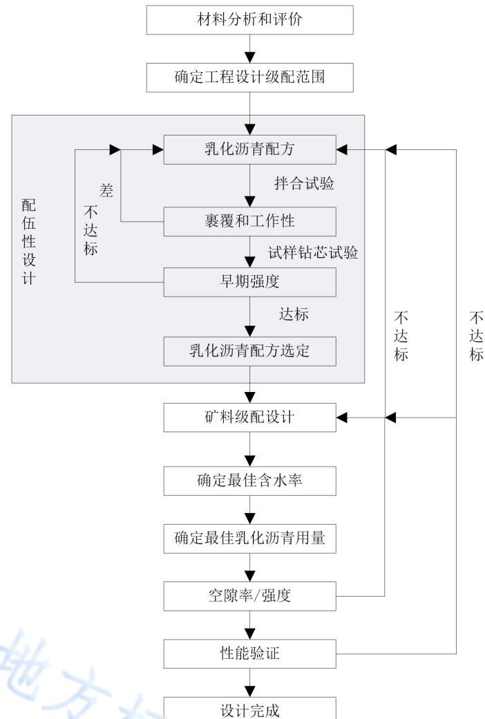
图 B.1 乳化沥青冷再生混合料配合比设计框图
